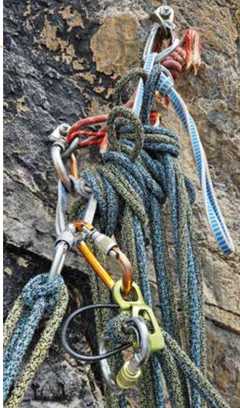
Bild 2: Ein Stand mit Halbseilen in der beschriebenen Methode – auch hier sind die Schlingen abgeknotet
